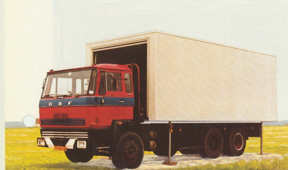
Het transport en de plaatsing geschiedt door één van de verschillende speciaal daartoe uitgeruste en ontworpen transport-auto's. Welk systeem gebruikt wordt is afhankelijk van het type
